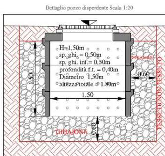
POZZO PERDENTE REALIZZATO CON ELEMENTI PREFABBRICATI IN C.A.V. Ø 150 cm - sp. 15 cm - REALIZZATO CON ELEMENTI AD INCASTRO H=50 cm GHIAIONE DI RIEMPIMENTO (granulatura 100-200 mm)
