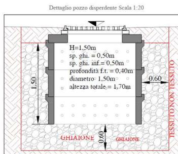
POZZO PERDENTE REALIZZATO CON ELEMENTI PREFABBRICATI IN C.A.V. Ø 150 cm - sp. 15 cm
