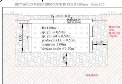
POZZO PERDENTE REALIZZATO CON ELEMENTI PREFABBRICATI IN C.A.V. Ø 200 cm - sp. 15 cm - REALIZZATO CON ELEMENTI AD INCASTRO H=50 cm
